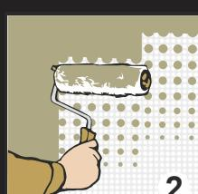
Нанесите велюровым валиком в один или два слоя краску-грунт «Uno Decor», заколерованную в тон покрытия. Время высыхания слоя 12 часов.
